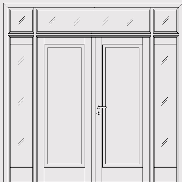
Doppio battente con fianchi-luce e sopraluce. Double-leaf door with sidelights and transom window.
